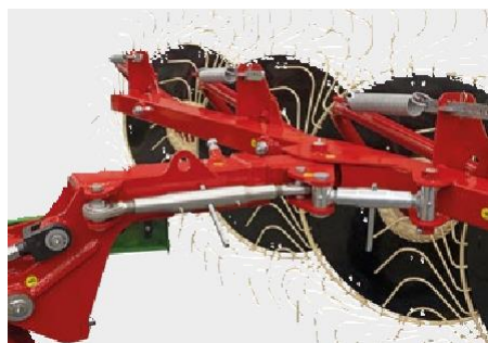
Nastavení úhlu hrabání a pracovní šířky pomocí ráčnového zvedáku. Nastavitelný závěs s ráčnovým zvedákem.
