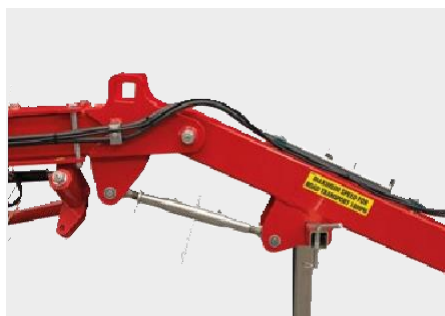
Nastavitelný závěs s ráčnovým zvedákem. Mechanické nastavení úhlu připojení.
